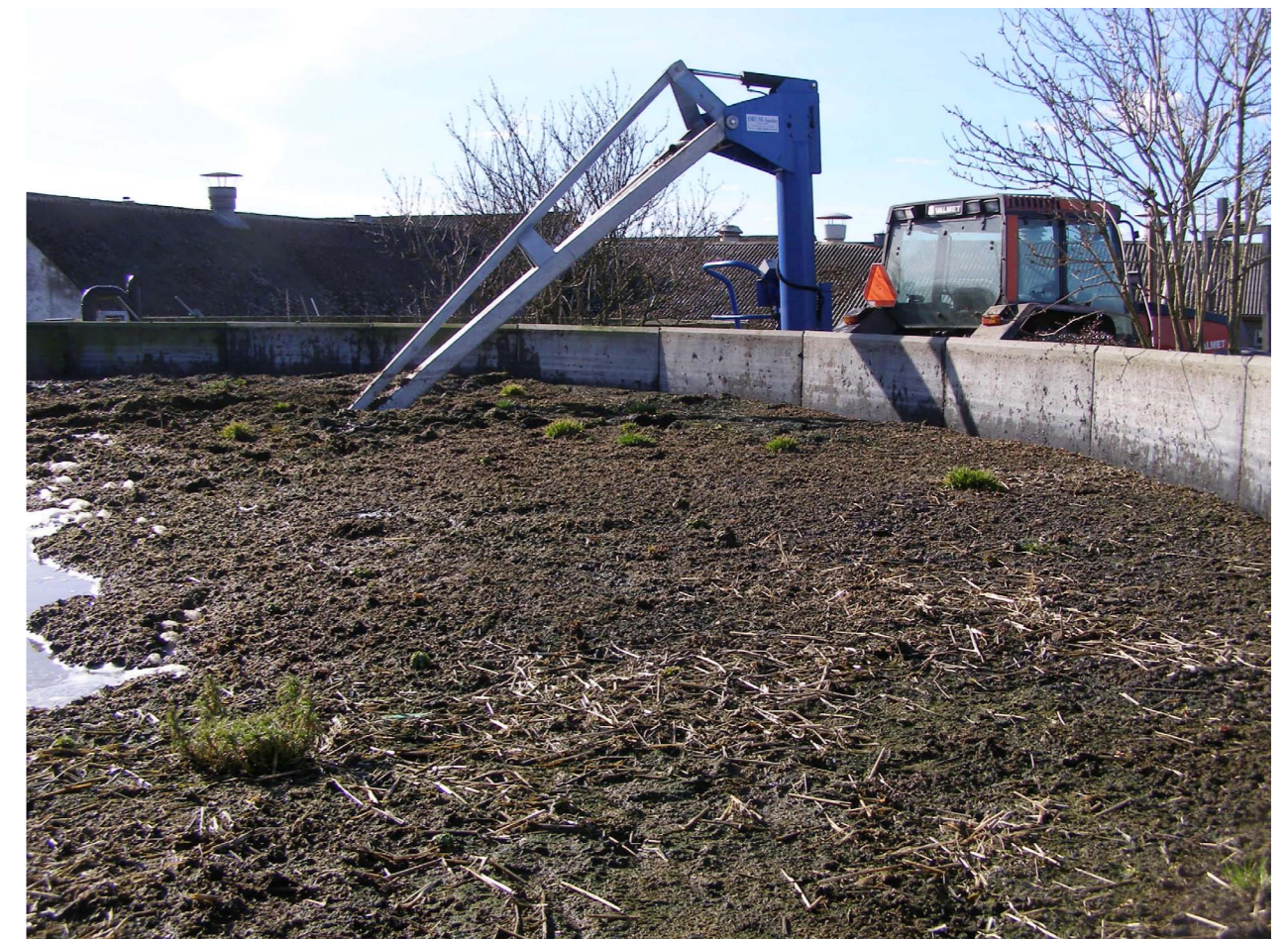
Ved omrøring frigives store mængder giftige og ildelugtende gasser. Foto: Jens J. Høy, AgroTech.
