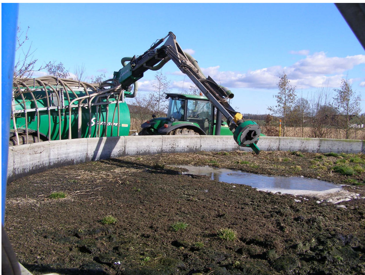
Pumpekran i form af en hydraulisk drevne pumpe på gyllevognen er en stor lettelse og en miljømæssig fordel, da gyllevognen ikke overfyldes. Foto: Jens J. Høy, AgroTech.
